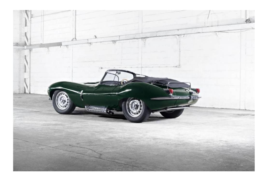
La Jaguar XKSS est débarrassée de l'aileron vertical caractéristique de la D-Type, et munie d'un pare-brise route plus haut et...d'une porte passager © DR
