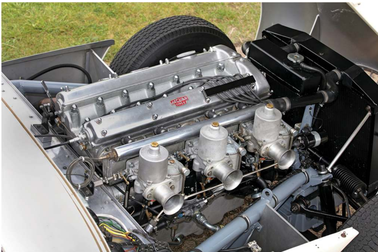
Le six-cylindres issue de la 120 était doté de triples carburateurs ?
