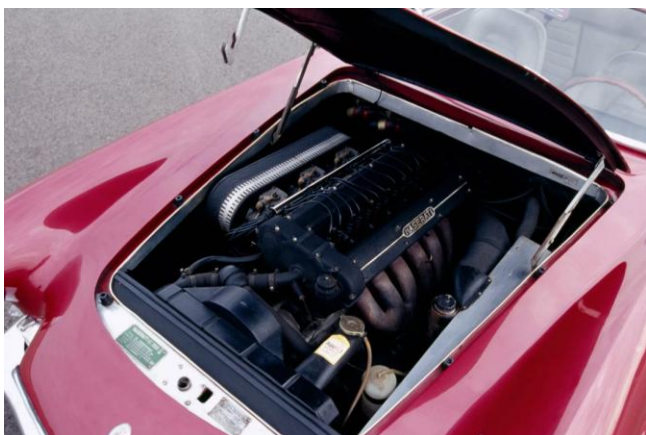
Le 6 cylindres en ligne, double arbre, ici en configuration injection Source : Archives Maserati
