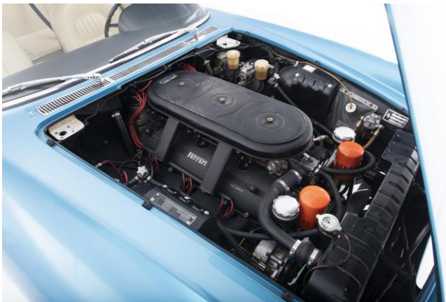
Le V12 de 5 litres de la 500 Superfast Source : Collection privée
