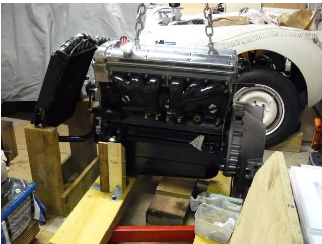
Etape 13 : Réalisation d'un banc pour démarrer le moteur avant de la reposer dans la voiture. Maquettage de la commande d'embrayage.
