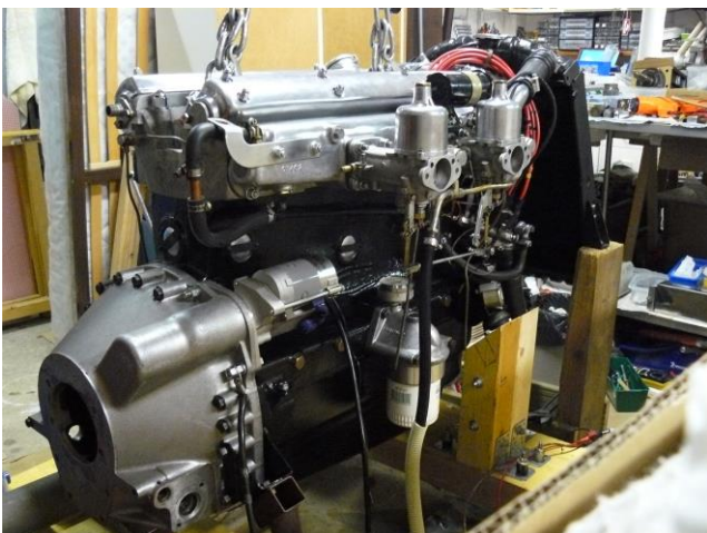
Etape 15 : Remontage de tous les périphériques permettant de démarrer le moteur sur son banc.
