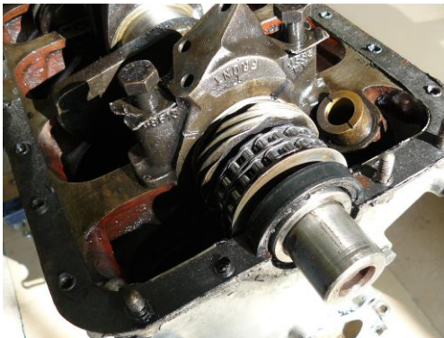
Poulie et le damper démontés
