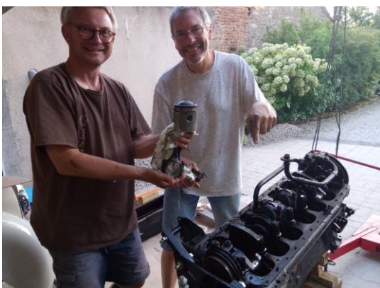
Première bielle et son piston démonté
