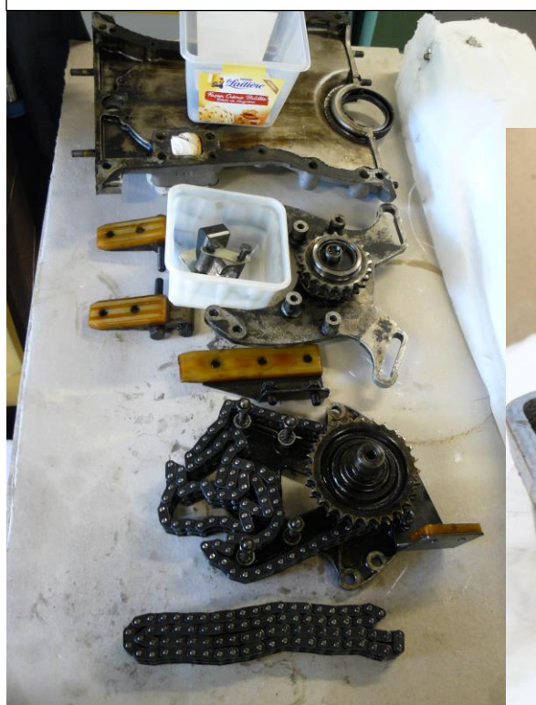
Ensemble des pièces constituant la distribution
