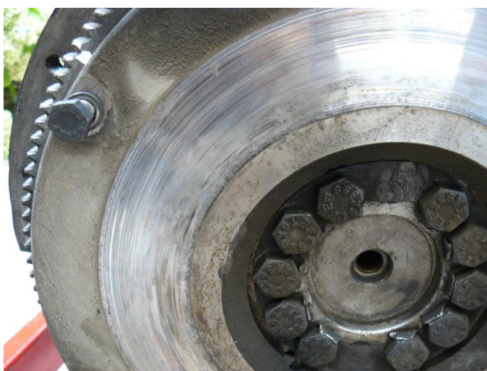
État du volant moteur
