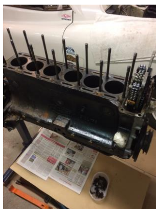
Bloc vidé de ses pistons et bielles
