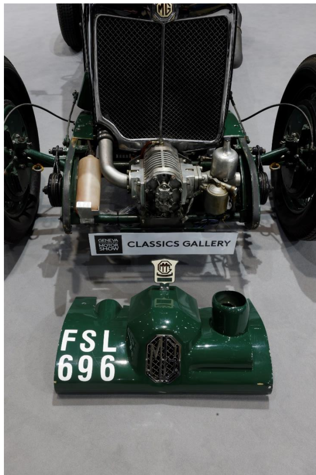
Légende : Le proéminent compresseur de la K3
