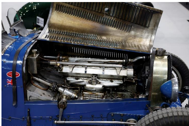
Légende : Moteur de la Bugatti 51 et son petit compresseur
